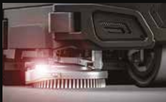
Boczna szczotka szorująca (dostępna dla wersji ze szczotkami tarczowymi)
